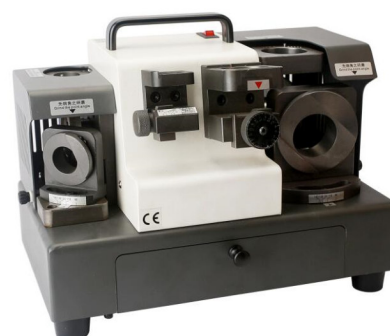
Modello Z32 dotata di 2 mole una per punte da d. 3 a 13 mm e l'altra per punte da d. 13 a 32 mm
